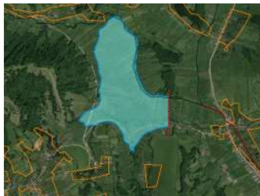
Acumularea nepermanentă Scrădoasa (amonte confluența cu râul Bărbat) V_{\text{reservoir}} = 1.5-2,0 \text{ mil. m}^3
