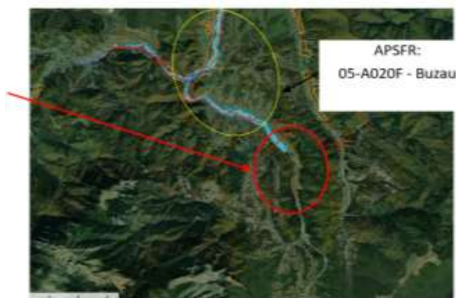
Acumularea nepermanentă Buzău, amonte de confluența cu afluentul Dălgheu V_{\text{reservoir}} = 7 \text{ mil. m}^3 H_{\text{dam}} = 30 \text{ m}
